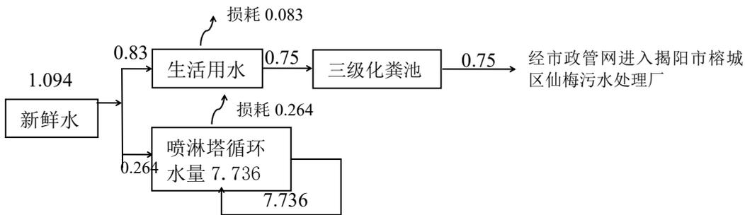
图 2-1 项目建成后全厂水平衡图 (t/d)
