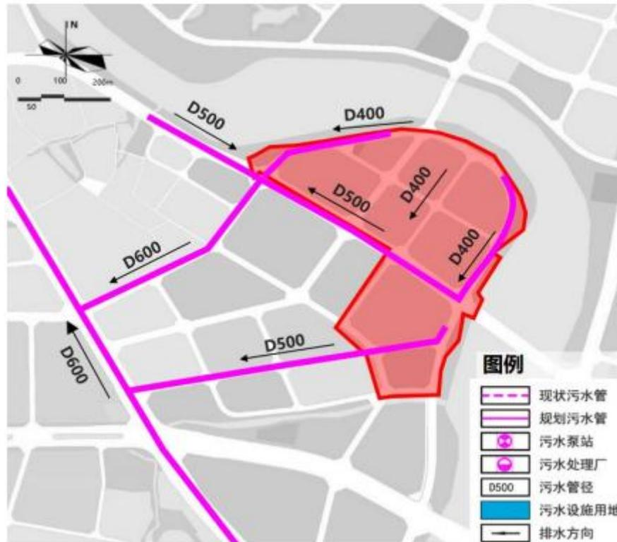
图 2-13 项目污水控规图
