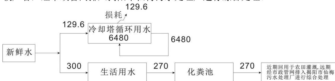
图 1 本项目水平衡图（单位为  $m^3/a$ ）
