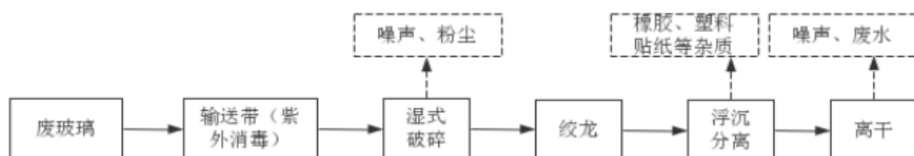
图 2-3 本项目玻璃湿式分拣清洗线生产工艺流程图
