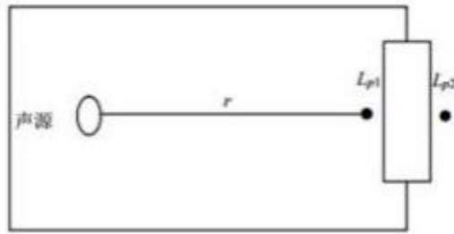
图 4-1 室内声源等效为室外声源图例
