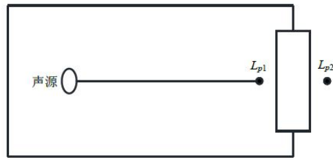
图 4-1 室内声源等效为室外声源图例
