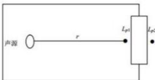
图 4-1 室内声源等效为室外声源图例
