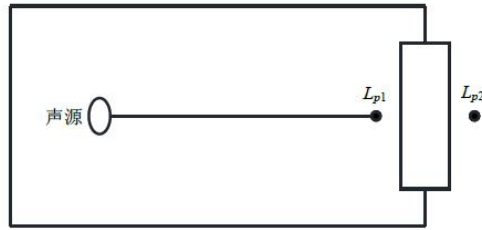
图 4-3 室内声源等效为室外声源图例
