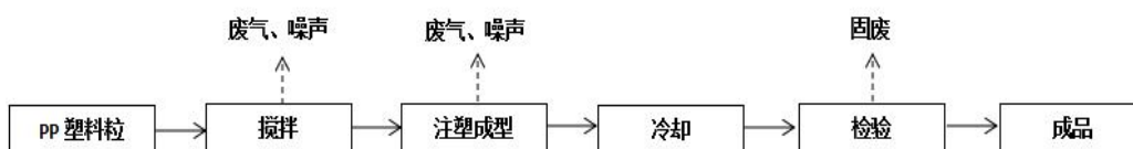
图 2-5 塑料卫生桶生产工艺流程图
