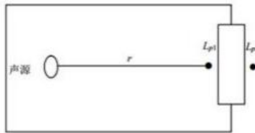
图 4-1 室内声源等效为室外声源图例
