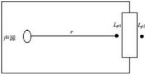
图 4-1 室内声源等效为室外声源图例
