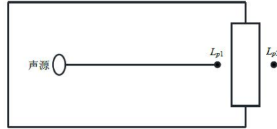
图 4-3 室内声源等效为室外声源图例
