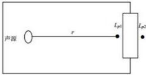
图 4-1 室内声源等效为室外声源图例
