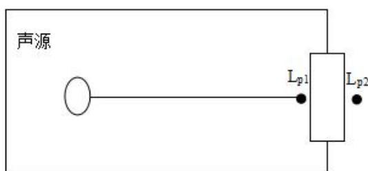
图 4-1 室内声源等效为室外声源图例
