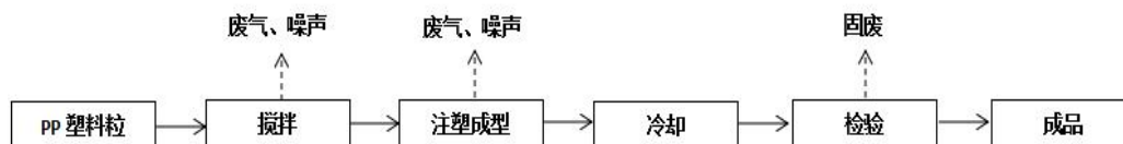
图 2-5 塑料卫生桶生产工艺流程图
