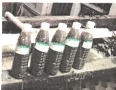
清洗废水处理前采样
