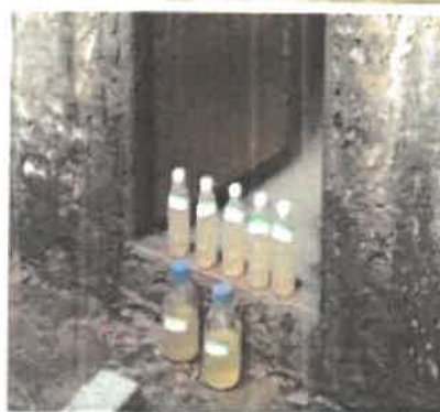
除尘废水处理前采样
