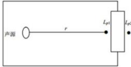
图 4-3 室内声源等效为室外声源图例
