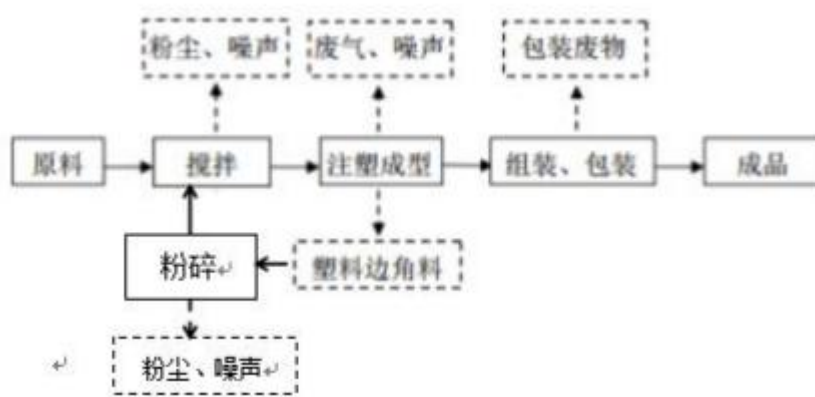
图 2-2 塑料鞋生产工艺流程及产污环节图
