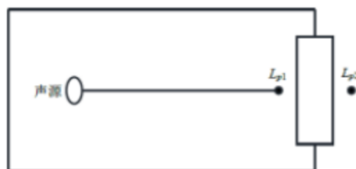
图 4-1 室内声源等效为室外声源图例
