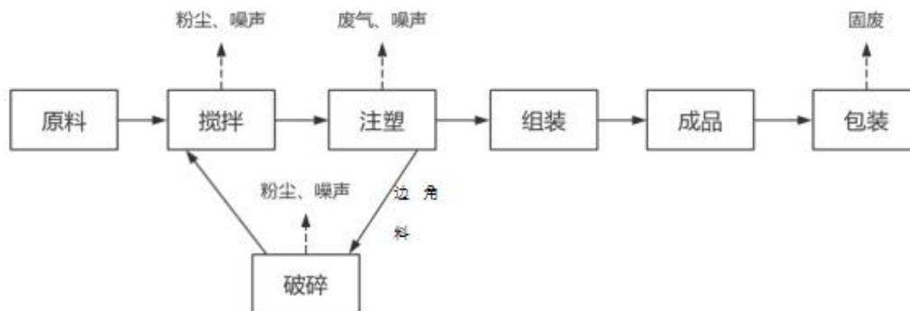
图 2-3 工艺流程图（镜子制品）
