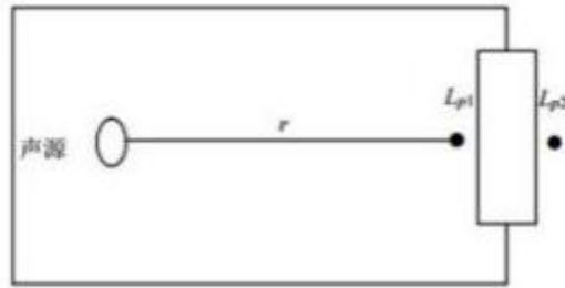
图 4-1 室内声源等效为室外声源图例
