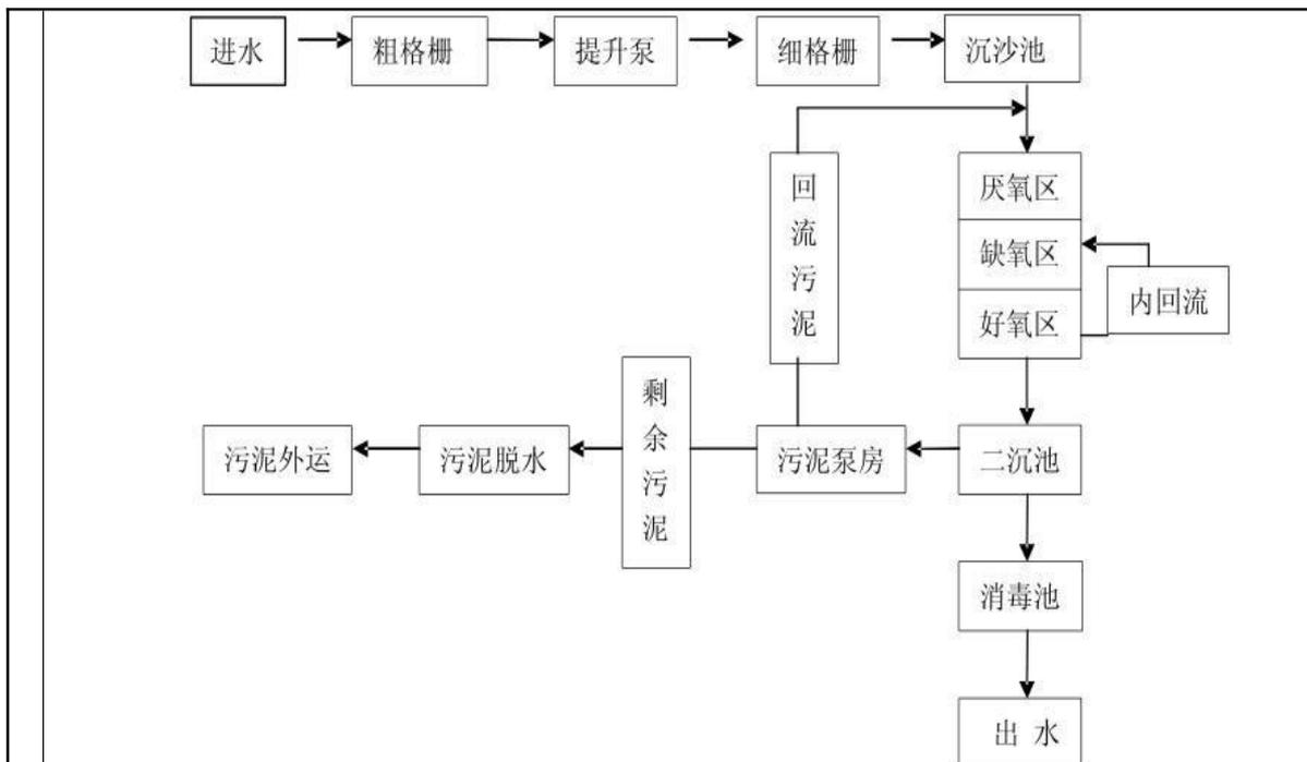
图 4.2-1 揭阳市区污水处理厂工艺流程图
