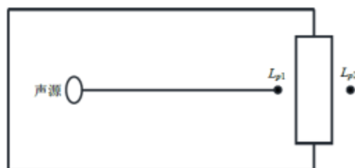
图 4-2 室内声源等效为室外声源图例
