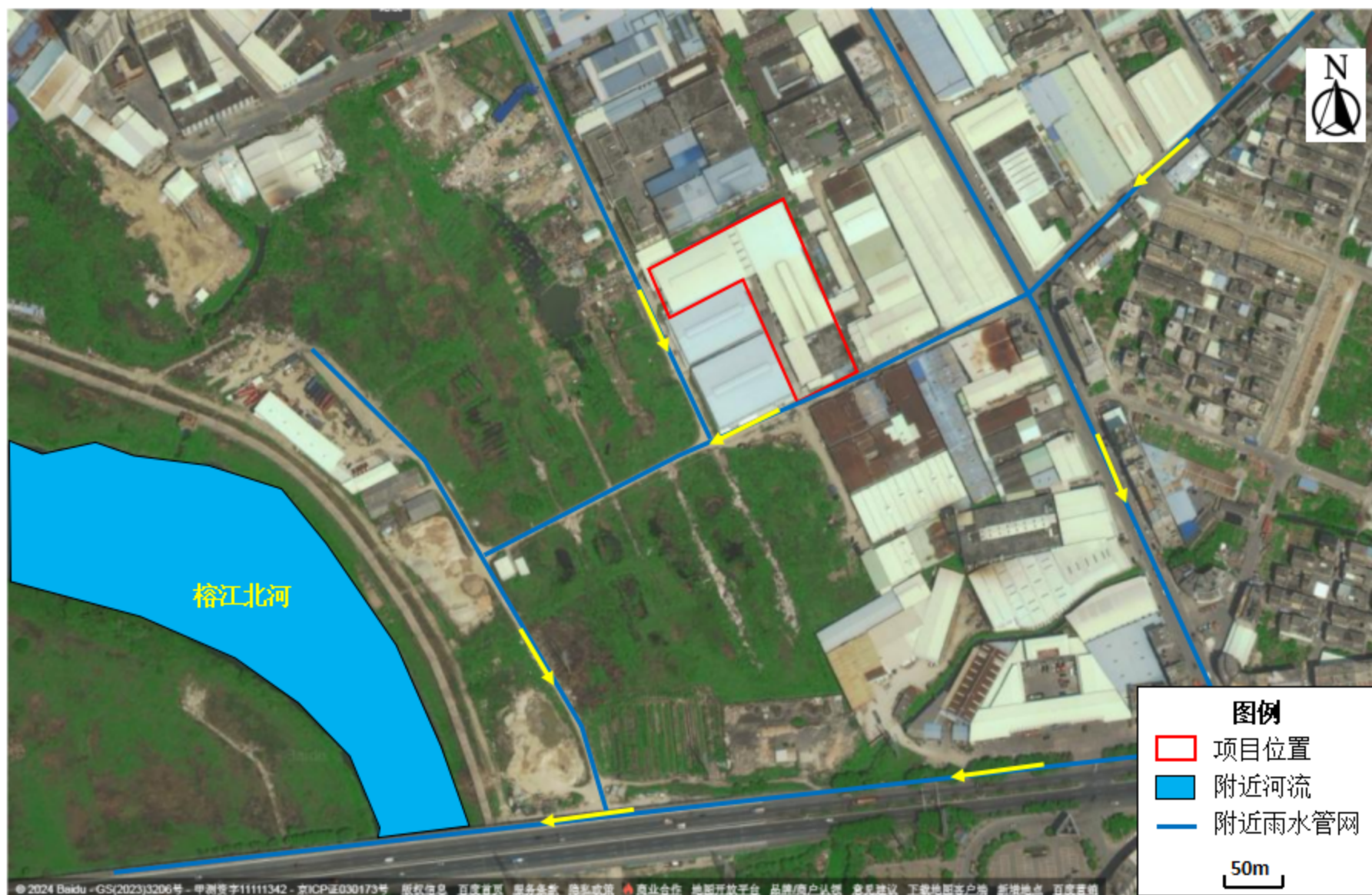
附图11 厂区雨水排放与附近河流的水力联系图
