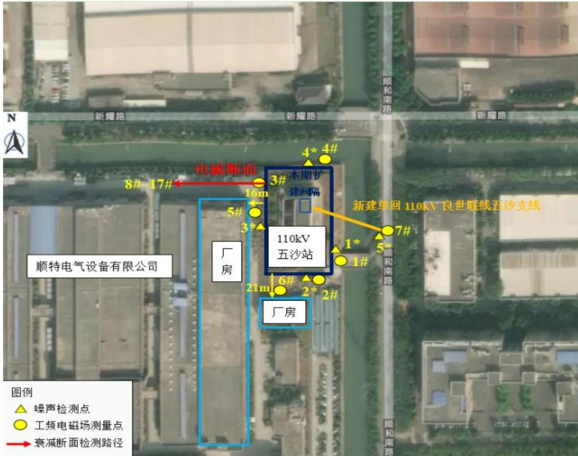
图 2 110 千伏五沙站监测布点图
