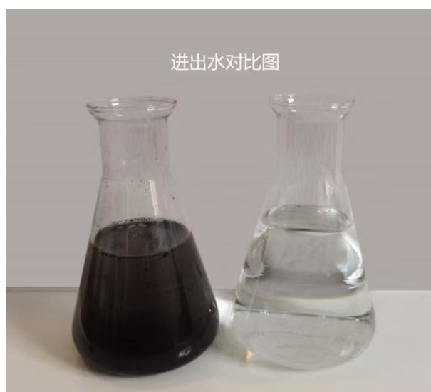
图 4-3 揭阳市嵘途环保设备工程有限公司除蜡清洗废水处理实验进出水对比图
