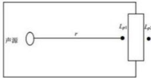
图 4.3-1 室内声源等效为室外声源图例
