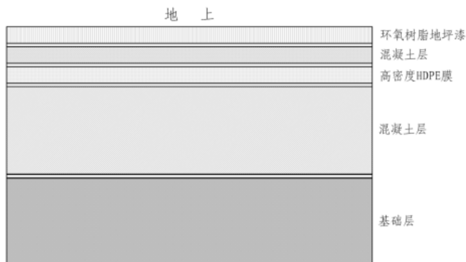
图 4-1 项目防渗层结构示意图
