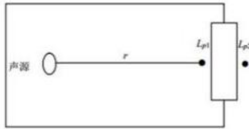
图4-1室内声源等效为室外声源图例
