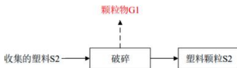
图 2-8 塑料破碎工艺流程图
