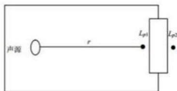
图4-2 室内声源等效为室外声源图例
