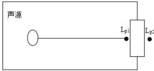
图 4-1 室内声源等效为室外声源图例
