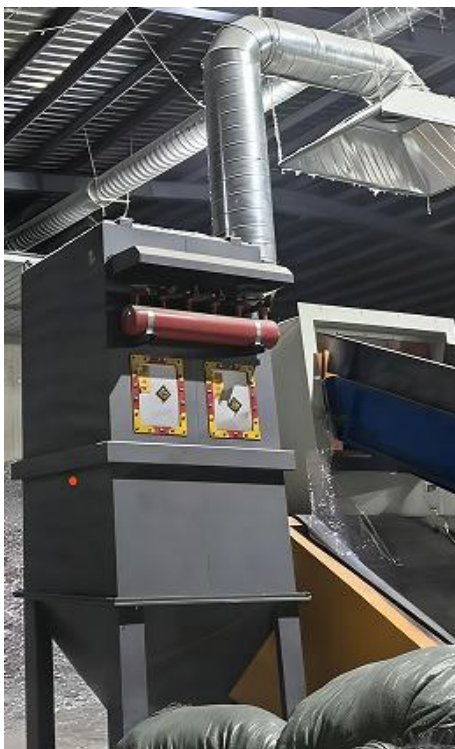
废气处理设施（处理破碎工序产生的颗粒物）及排气筒DA002
