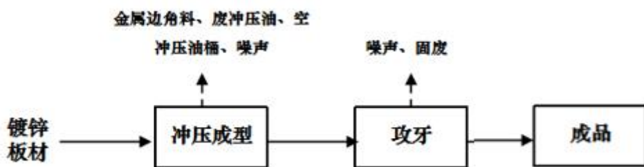
图 2-5 电机壳（镀锌板材）生产工艺流程图
