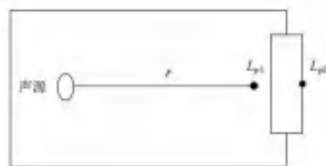
图4-1 室内声源等效为室外声源图例
